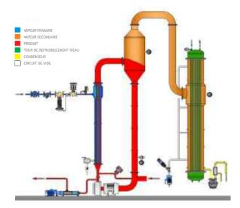
Une unité de base et un condensateur pour condenser les vapeurs extraites de l'échangeur de chaleur. Le produit circule jusqu'à obtenir la concentration désirée, mesurée par le refractomètre. Une fois atteinte, une pompe lobulaire extrait le produit.
